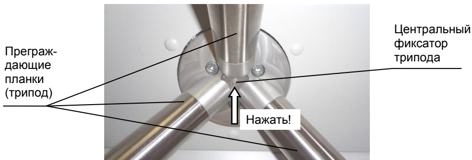
Рис.3 Место расположения центрального фиксатора трипода
