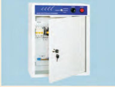
Шкаф контрольно-пусковой работает совместно с прибором «Карат» и предназначен для автоматического или ручного управления трехфазными двигателями (насосы, вентиляторы, приводы исполнительных механизмов и т.д.) в составе систем пожаротушения и дымоудаления на производственных объектах, в жилых и общественных зданиях.
