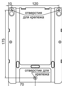
Рис.1 Основание. Присоединительные размеры
