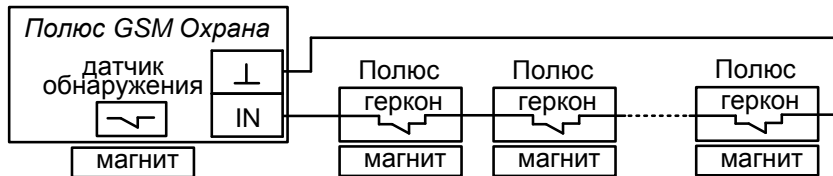
Рис.6а Схема подключения внешних датчиков. Значение «2» параметра №37
